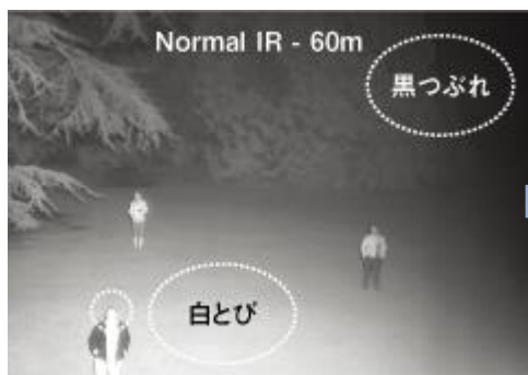
従来の赤外光照明の映像 配光が不均等で、中心部には白飛び、周辺部には黒つぶれがあり、適正な映像エリアは狭く短い。
