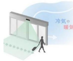
eスムースセンサーは人の進む方向を見極めることで、 unnecessary 自動ドアの開閉を低減します。
